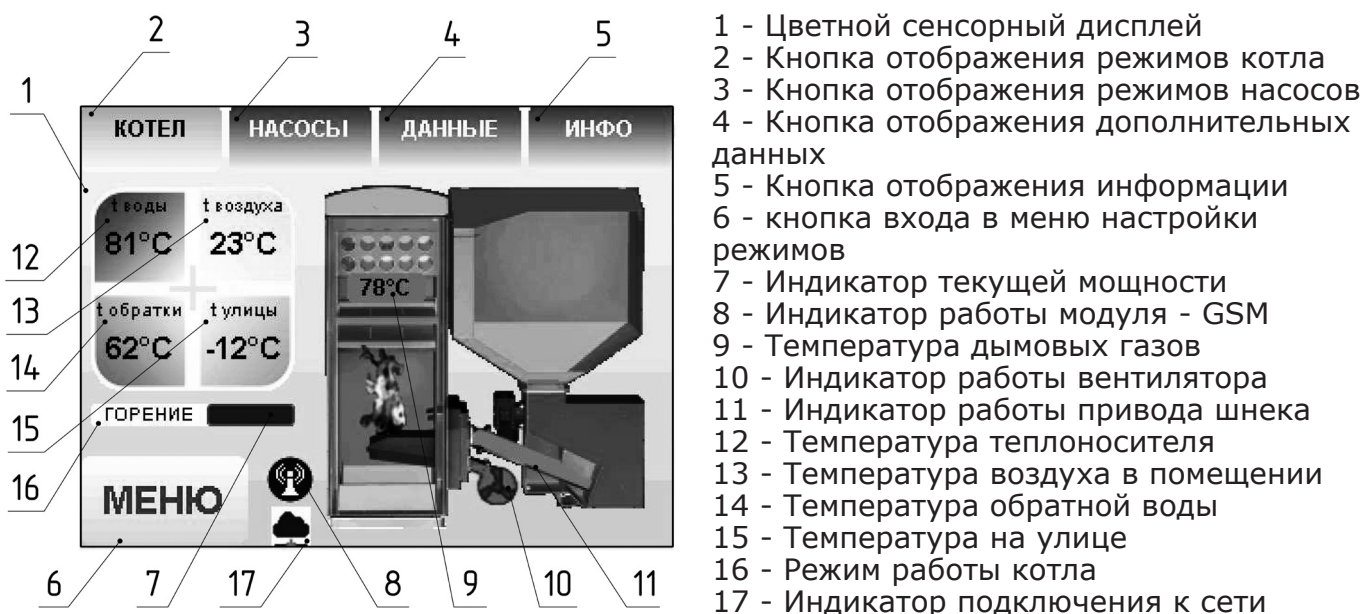
Рис.8 Расположение органов управления и индикации на передней панели пульта управления.
